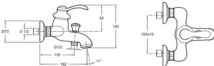
Спецификация продукта: Настенный смеситель для ванны/душа. E71090. Коллекция: FAIRFAX. ВЕС: 2,2 кг. ТИП УСТАНОВКИ: Крепление к стене. ТИП: Однорычажный. РАСХОД ВОДЫ: 20 л/мин при давлении 3 бар. ПОДКЛЮЧЕНИЕ: С настенными крепежами и кольцами. МЕХАНИЗМ: Керамический картридж. СЛИВ: 0. ОДНОРЫЧАЖНЫЙ СМЕСИТЕЛЬ: 0. УСТАНОВКА: Настенные. ГАРАНТИЯ НА ОТДЕЛКУ: 10 лет. Однорычажный смеситель в стиле ретро. Аэратор с антиизвестковым покрытием. Встроенный держатель для душа.
